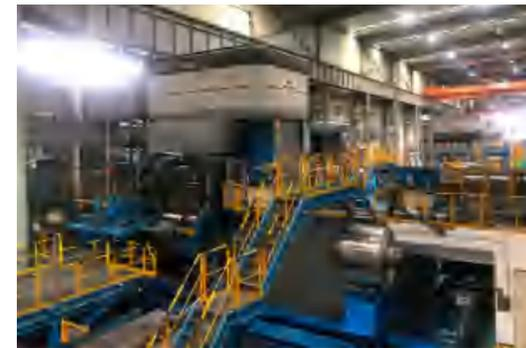
图：中孚高精铝材 2500mm 单机架冷轧机
